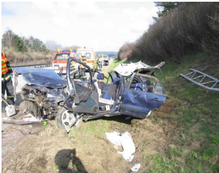
Foto pplk. Ing. Vladimír Menšík, ŘSDP PP ČR - následky nárazu do reklamního zařízení podél dálnice na údajně bezpečných deformovatelných konstrukcích
